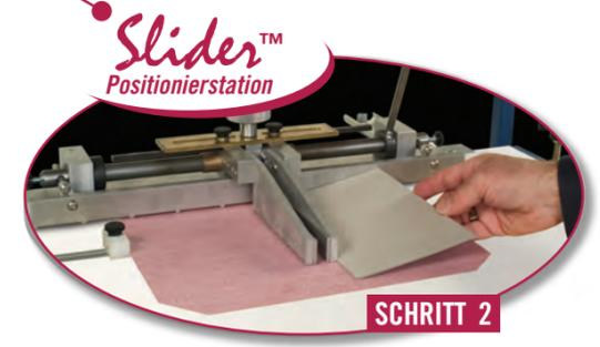
**Mittels Schablone werden die Pappenteile an Anschlägen ausgerichtet.**
