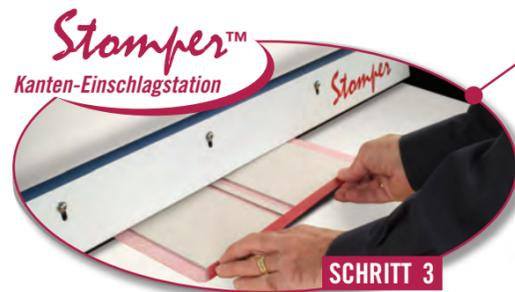
**Alle vier Seiten des Bezugsstoffes werden an den Pappekanten eingeschlagen.**
