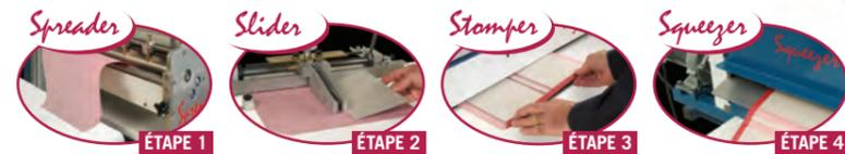
**Spreader™** – Matériau de couverture est encollé sur le côté supérieur.
