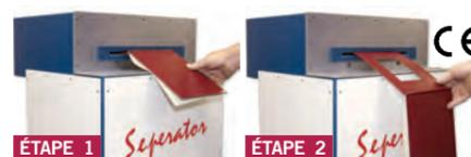
L'opérateur insère la couverture jusqu'à la butée dans la «boîte aux lettres», presse sur la pédale et enlève le livre complété avec une «fenêtre».
