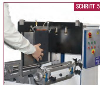
Nach dem Schließen des Buchs wird der Saugarm (manuell) zurück in die Ausgangslage gekippt und das Buch entnommen.
