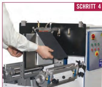
Der Umschlag wird durch die Bedienperson ganz einfach geschlossen.
