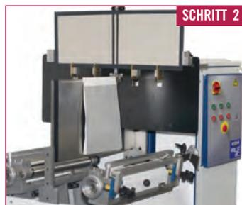
Die geöffnete Decke wird in die Umschlagführung eingeführt. Der Rücken des Umschlags wird durch Saugluft festgehalten. Der Buchblock wird ganz normal auf den Flügel gelegt.
