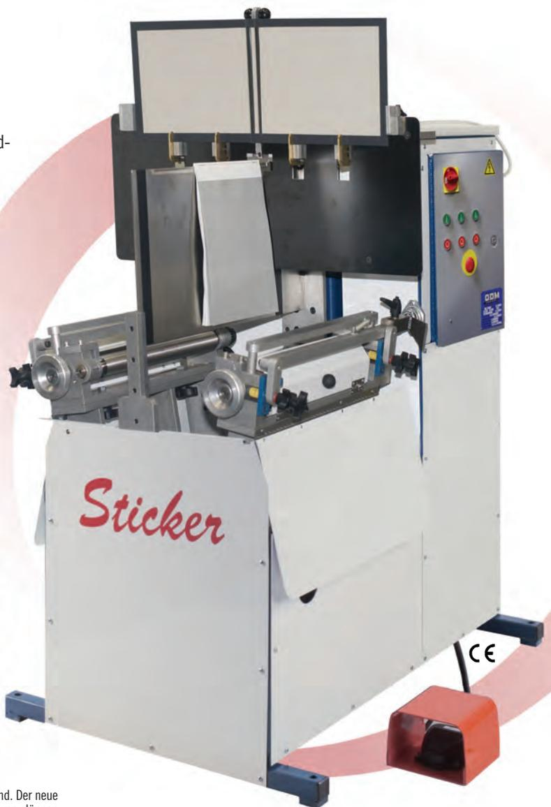
Bei Einhängemaschinen nach dem Flügelprinzip war der Einhängvorgang immer schwierig und anstrengend. Der neue ODM Sticker mit der speziellen Dünnpunkte-Führung erleichtert das präzise Positionieren der Decken von dünnen Produkten enorm. Zusätzlich kann Produktionszeit gespart werden, da das manuelle Vorformen der Umschläge entfällt.
