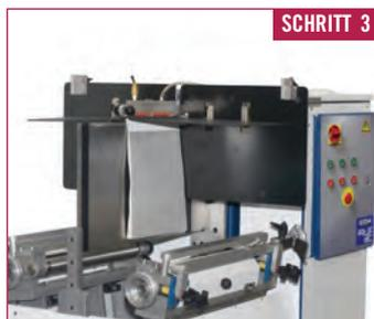
Wenn der Flügel in der oberen Endposition ankommt, wird die Deckenhalterung (von Hand) abgesenkt und mit dem Rücken des Buchblocks in Kontakt gebracht.
