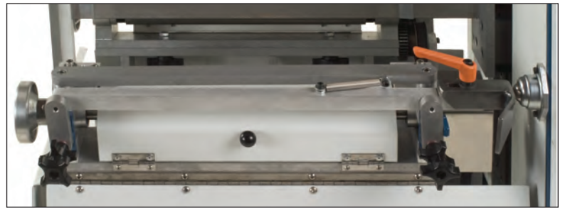
Verstärkter Leimauftrag (Option) im Scharnierbereich des Buchrückens
