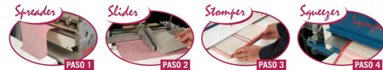
Paso 1: **Spreader** El material de la tapa pasa a través del encolador y recibe cola en la cara superior
