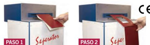
El operador introduce la tapa a través de una hendidura de seguridad y en seguida actúa sobre un pedal para el troquelado
