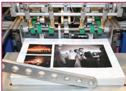
Greifer fördern die ausgerichteten Bogen durch die Rill-, Falz- und Pressstationen des Sidewinder™ Bindesystems
