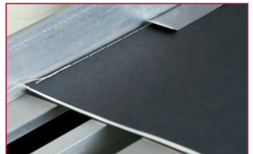
Rückstich garantiert eine starke und haltbare Seitenheftung
