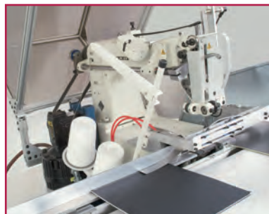
Sich selbst einstellende, automatische Inline Heftung
