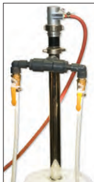
Hotmelt-Auftragsgerät Nordson (Option) zur Verstärkung der Scharnierzone und die Kaltleimpumpe (PVA) mit elektronischer Steuerung für einen präzisen Düsenauftrag.
