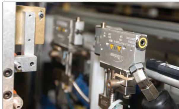
Hotmelt-Auftragsgerät Nordson (Option) zur Verstärkung der Scharnierzone und die Kaltleimpumpe (PVA) mit elektronischer Steuerung für einen präzisen Düsenauftrag.
