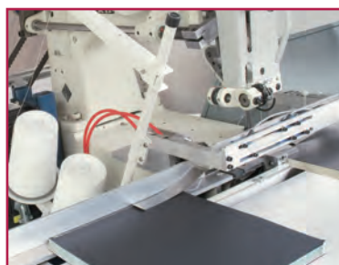
Sich selbst einstellende, automatische Seitenheftung
