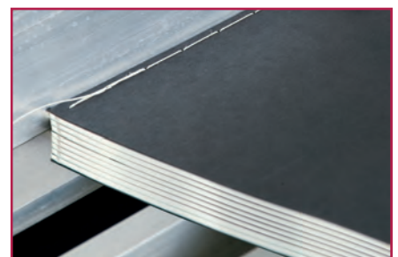
Rückstich ergibt eine starke Seitenheftung bis zum dicksten Buch
