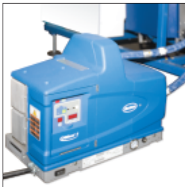
Hotmelt-Auftragsgerät Nordson (Option) zur Verstärkung der Scharnierzone und die Kaltleimpumpe (PVA) mit elektronischer Steuerung für einen präzisen Düsenauftrag.
